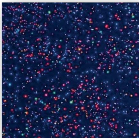
Les particules brillantes sont des particules invisibles hautement luminescentes. Ces particules sont classées en fonction de leur taille, puis placées dans le papier lors de sa fabrication.
