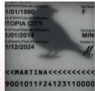
Cette caractéristique semblable à un filigrane donne une sécurité supplémentaire au document. Dans le rayonnement infrarouge (850-950 nm), l'image de l'oiseau uniquement (sans rameau) apparaît comme une faible image d'ombre. La zone MRZ reste totalement libre d'éléments absorbant les IR, conformément aux recommandations de l'OACI 9303.
