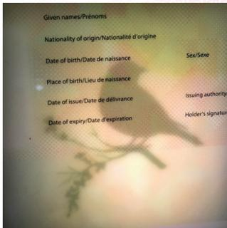
Cet élément de sécurité est imprimé à l'intérieur de la page de données, agissant comme un filigrane. En tournant la page de données vers une source lumineuse puissante, l'image d'un oiseau assis sur un rameau devient visible.
