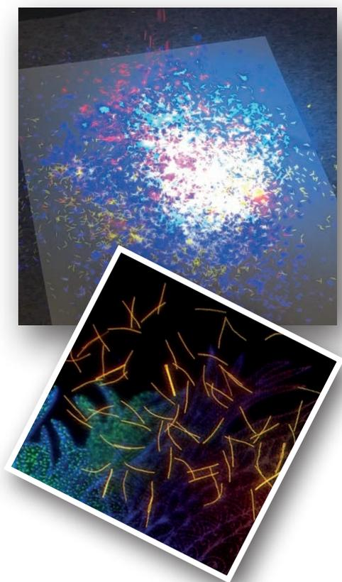
Las fibrillas de seguridad se utilizan desde hace años para aumentar el nivel de seguridad de los documentos basados en papel. ANY produce diversas fibrillas de seguridad de color o incoloras, fluorescentes o no fluorescentes, de distintas longitudes y números DTEX que pueden fabricarse con material de viscosa o poliamida.
