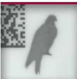
Image invisible absorbant les IR
