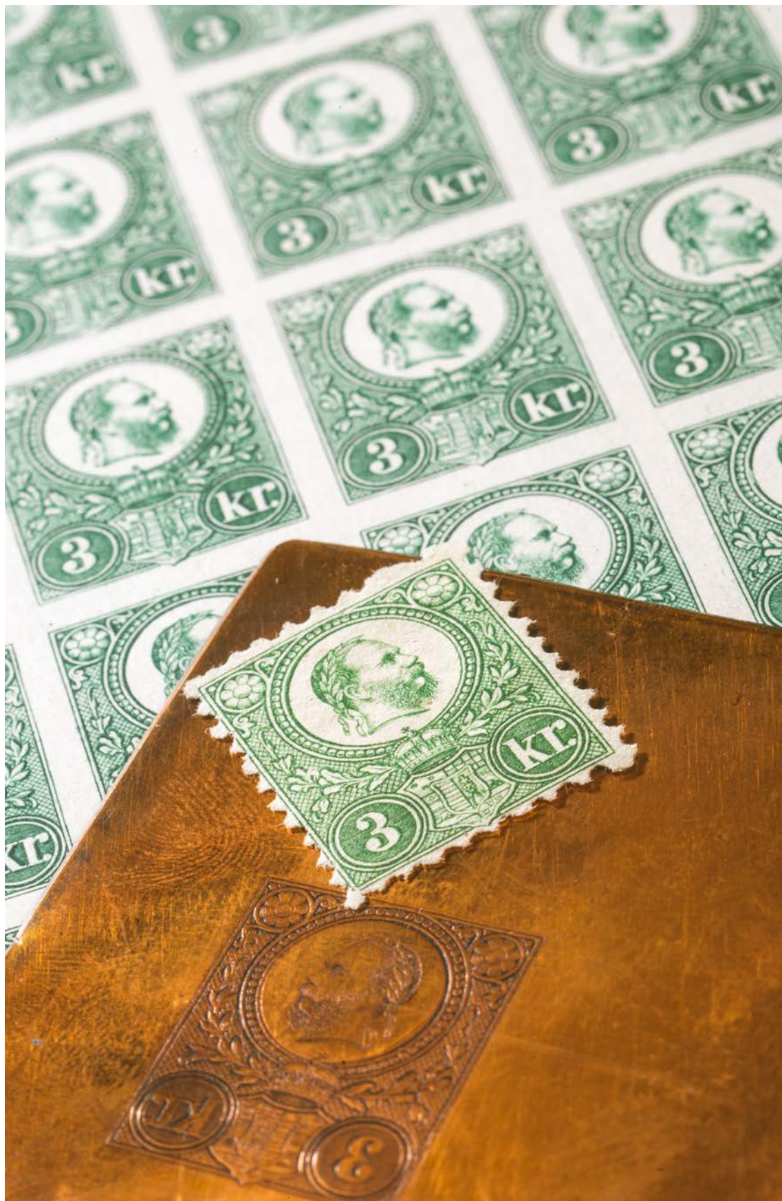
Az 1871-es bélyegkiadás réznyomású változata, a nyomóforma-készítés galvánmáslataival
